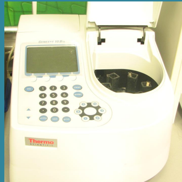
Espectrofotómetro, cuantificación de Ácidos nucleicos y otros compuestos
