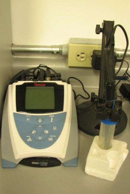
Potenciómetro, medición de PH
