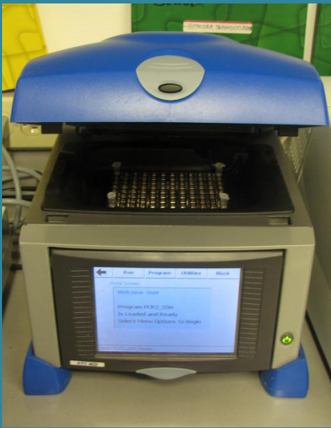
Termociclador de gradientes. PCR, amplificación de ADN
