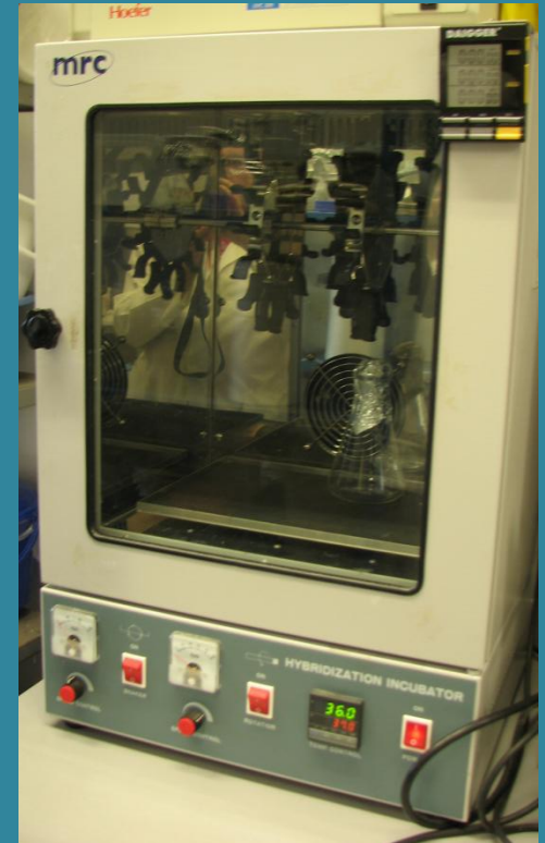
Horno de Hibridación e incubadora 68 °C
