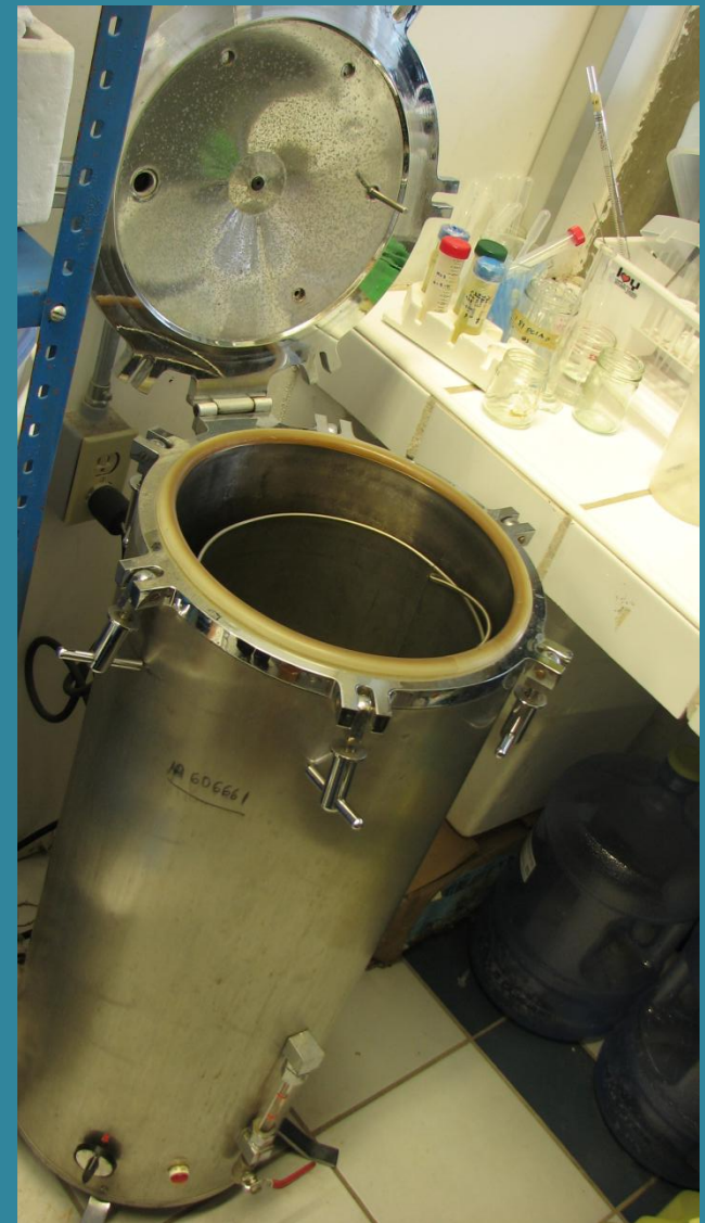
Autoclave semiautomática esterilizar
