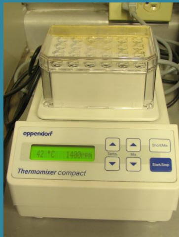
Vortex con control de temperatura y agitación, para crecimiento de bacterias y hongos en cultivo
