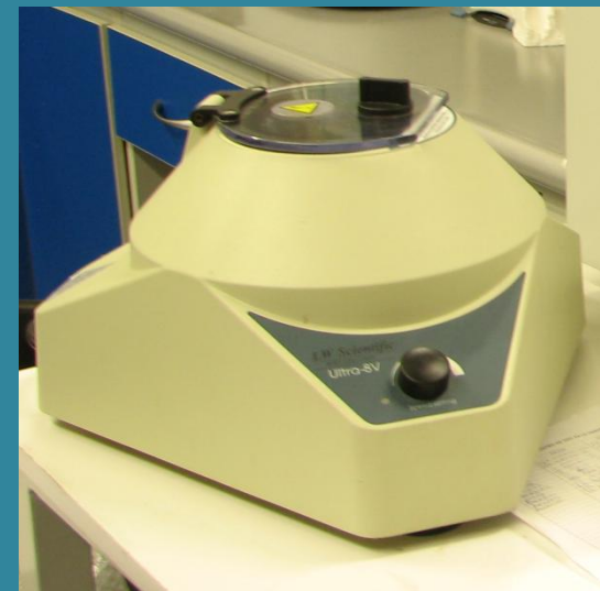
Centrifuga clínica separación de muestras y precipitación celular
